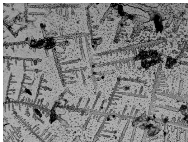
Рис. 4. Отсутствие вершины кристалла (отросток 1-го поколения отходит от вершины кристалла) CWT. ASS – есть.
