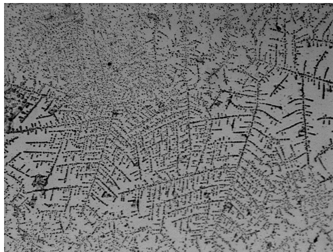
Рис. 8. Кристалл с разрывом структуры CGS.
