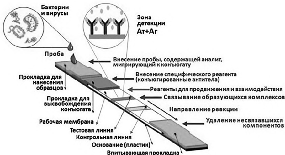
Рис. 2. Схематическое представление механизма иммунохроматографического тестирования (иммуноанализа латерального потока). Образец (проба), содержащий исследуемый антиген (аналит) наносится на прокладку для нанесения образца и мигрирует к конъюгату. Конъюгированные антитела связывают целевой анализ и мигрируют к тестовой линии, где целевой анализ связывается с антителами (рисунок авторов).
